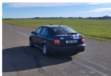
Obr. 4 – profilometr pro měření míry nerovnosti C
