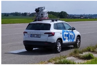
Obr. 5 – jedno skenerový MMS
