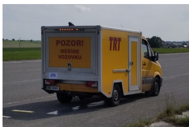
Obr. 3 – Profilometr s lineárním snímačem vzdálenosti
