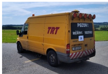
Obr. 2 – Profilometr s dvou hmotovým odezovým systémem
