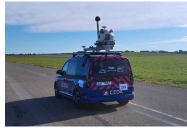
Obr. 6 – dvou skenerový MMS
