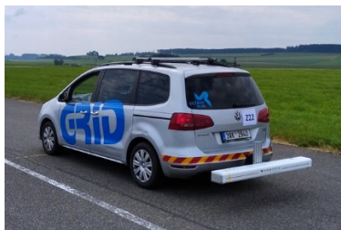
Obr. 1 – profilometr s laserovým snímačem vzdálenosti
